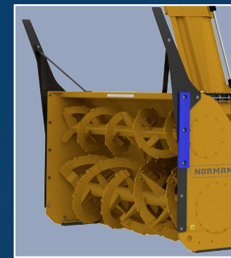
Couteaux latéraux fixes en acier Hardox 450 et déviateur de camion
